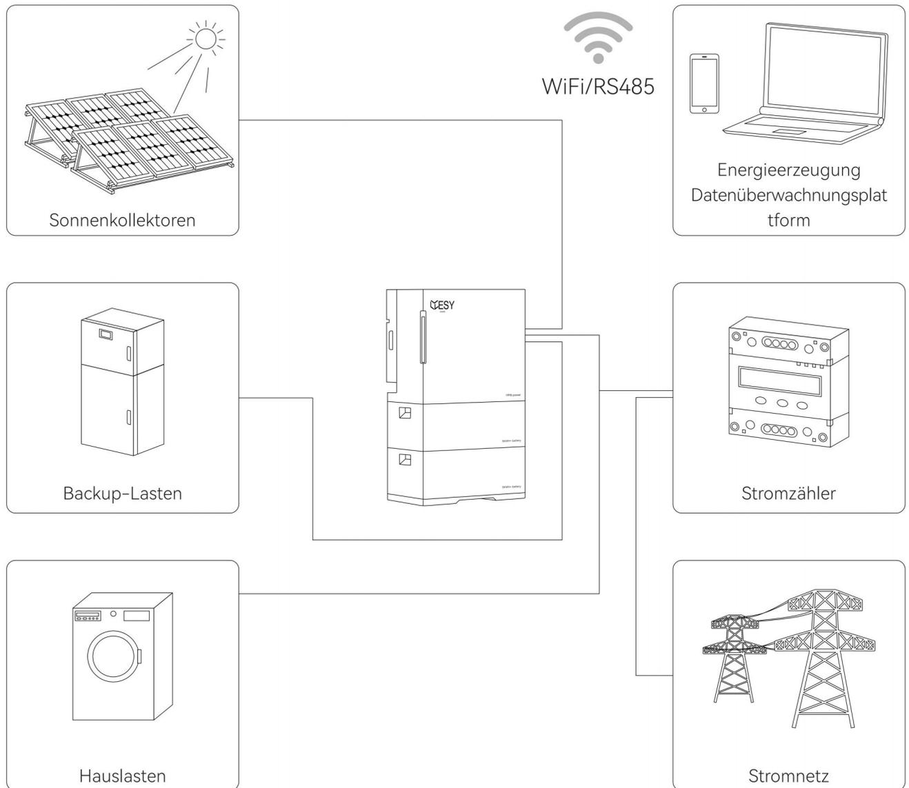
Das HM6-Energiespeichersystem für Privathaushalte ist mit einem 6-kW-Wechselrichter, 5 bis 30-kWh-Batterien und Internetanschlüsse ausgestattet und kann an das Stromnetz, PV-Module und Mobiltelefone angeschlossen werden, um Haushalte, kleine Unternehmen oder landwirtschaftliche Betriebe mit Strom zu versorgen.
