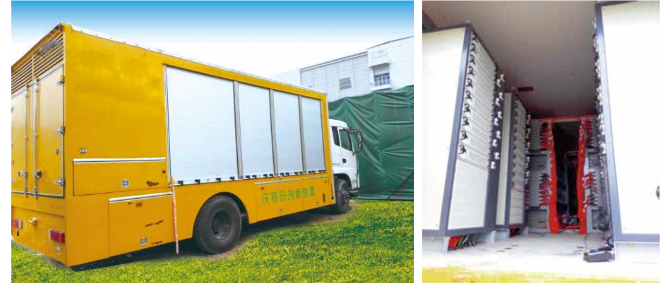
► Mobiles Energiespeicherfahrzeug der Firma OptimumNano Energy
