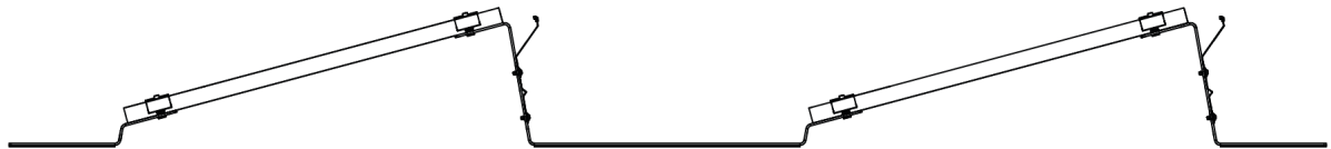
SYSTEM S15 | 790 MM REIHENABSTAND | 18° VERSCHATTUNGSWINKEL
